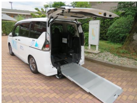
車いすスロープ
